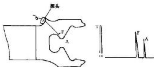
图 A9 有汽封菌型叶根检验时动态波形图
